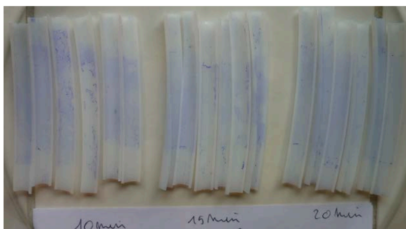
Foto 3. Verkleurde biofilmresten na reiniging met de Sterilex-producten. Van links naar rechts: 10, 15 en 20 minuten circulatie.
