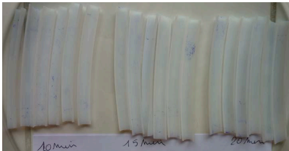
Foto 4. Verkleurde biofilmresten na reiniging met de Realco-producten. Van links naar rechts: 10, 15 en 20 minuten circulatie.
